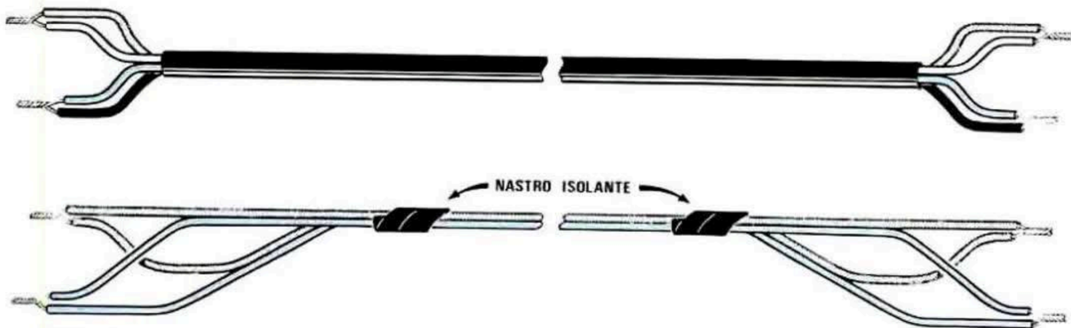
Fig.16 Se volete costruirvi degli ottimi cavi per altoparlanti, con caratteristiche analoghe ai cavi più costosi, potrete acquistare un cavo da elettricista a 4 conduttori, ponendo in parallelo 2 fili. Potrete anche utilizzare due comuni piattine bifilari, non dimenticando di tenerle "unite" con un giro di nastro isolante ogni 10 centimetri.
