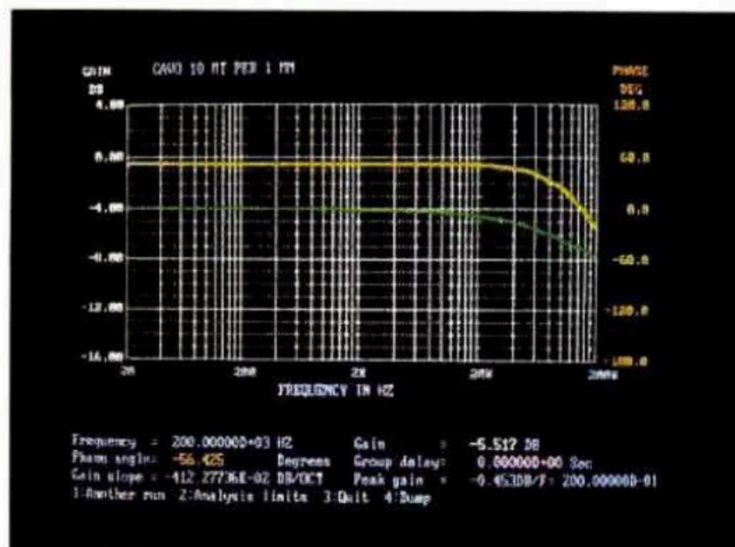
Fig.2 Controllando con un'adeguata strumentazione un comune cavo provvisto di un filo di rame del diametro di 1 mm, il segnale si attenua di 3 dB oltre i 120.000 Hz, cioè su frequenze non udibili ad orecchio.
