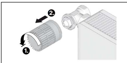
4. Applicare il meccanismo alla base della valvola come indicato in figura; se necessario, utilizzare l'adattatore appropriato
