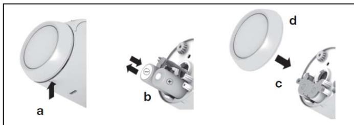
2. Rimuovere il cappuccio o la testina termostatica dalla valvola da radiatore
